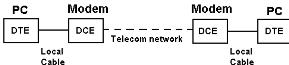
Рис. 88. Соединение двух удаленных терминалов при помощи модемов.
