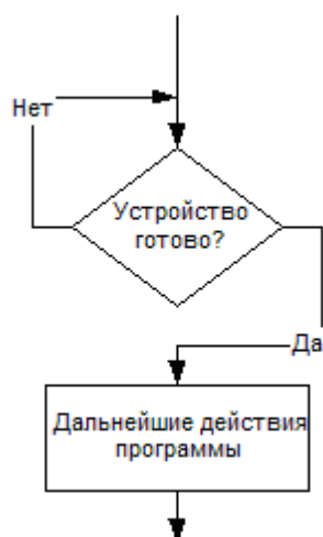
Рис. 19. Нерекомендуемый подход к обмену с устройством
