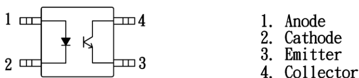
Рис. 52. Оптрон КРС357, состоящий из светодиода и фототранзистора.
