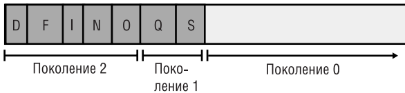
Рис. 20-15. Вид кучи после четырех сборов мусора: выжившие объекты из поколения 1 переходят в поколение 2, выжившие объекты из поколения 0 переходят в поколение 1, а поколение снова 0 пусто
