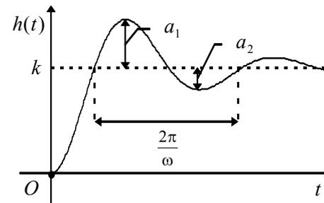
где  $\sigma = \zeta/T$ ,  $\omega = \frac{1}{T} \sqrt{1 - \zeta^2}$ . Параметр  $\omega$  легко определяется по графику переходной функции, а параметр  $\sigma$  находится посредством выражения
