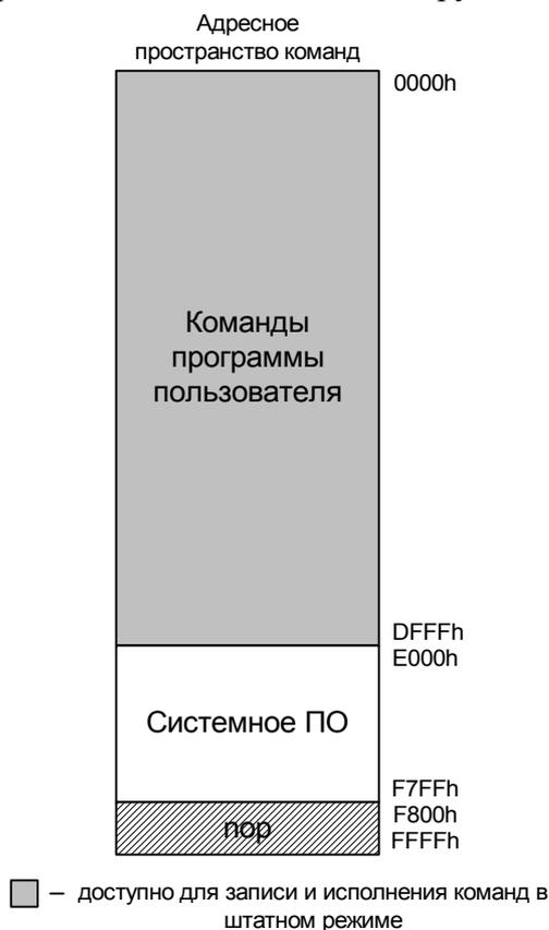
**Рисунок 2. Размещение программ в SDK-1.1 с ADuC83x, ADuC84x.**
