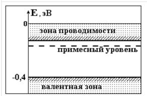
На рисунке представлена энергетическая схема примесного полупроводникового фотокатода, работающего при температурах ≈ 90К. Значение энергии электронов примеси равно -0,04 эВ. Значение энергии электронов дна зоны проводимости -0,03 эВ. Ширина запрещенной зоны 0,6 эВ. Определите количество наблюдаемых максимумов в спектральной зависимости фототока и фотопроводимости при падении на фотокатод излучения с энергией 0,02 эВ.
