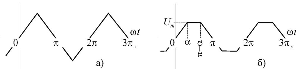
Выходное напряжение усилителя *a)* и исследуемый сигнал  $u_4(\omega t)$  *б)*
