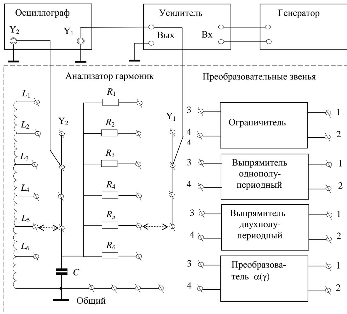
Рис. 6.1. Схема лабораторной установки
