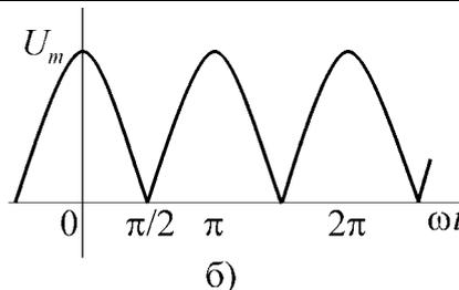
Выходное напряжение усилителя *a*) и исследуемый сигнал  $u_8(\omega t)$  *б*)
