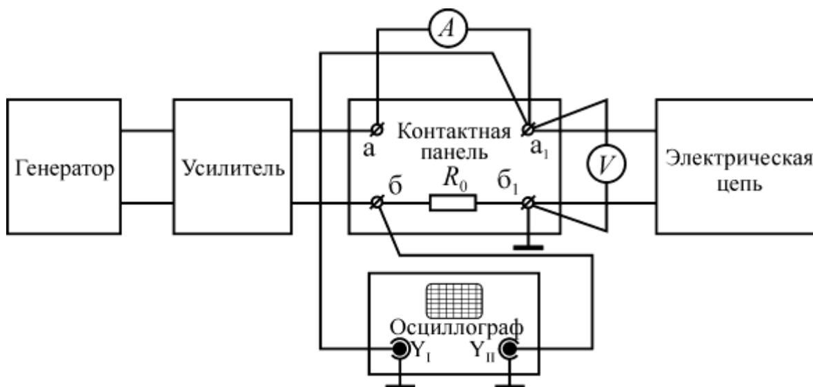
Рис. 3.1. Схема лабораторной установки
