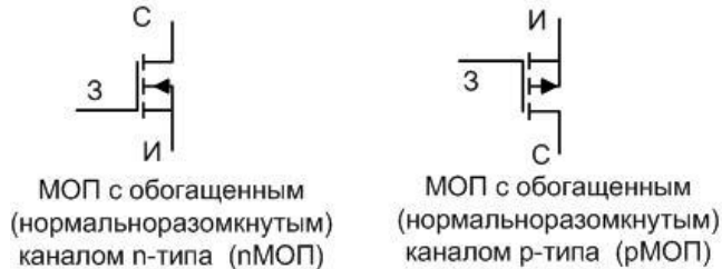
Рисунок 4 Условные обозначения МОП-транзисторов
