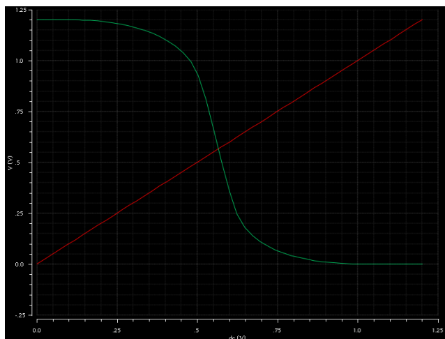
Рис. 5: Результаты моделирования переходной характеристики
