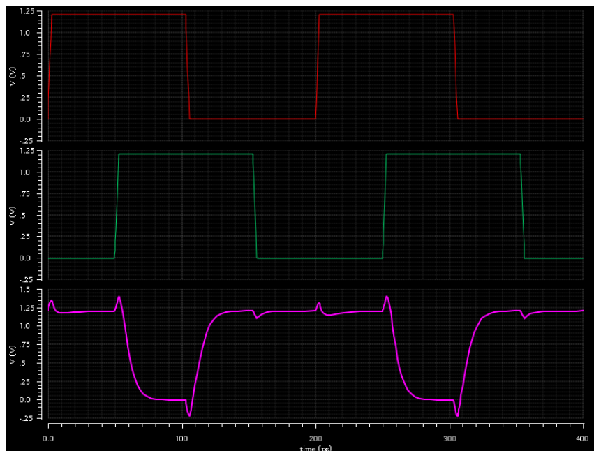
Рис. 8: Временная диаграмма работы клапана И-НЕ
