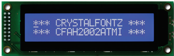
Рис. 8.49 ЖК-дисплей CFAN2002A-TMI 20 x 2 фирмы Crystalfontz (напечатано с разрешения Crystalfontz America ©, 2012)
