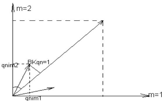
Каждый вариант решения на плоскости образует вектор качества. В рамках данной интерпретации получаем, что вариант решения характеризуется длиной вектора качества и величиной угла с неким идеальным вектором, или длиной проекции на идеальный вектор:
